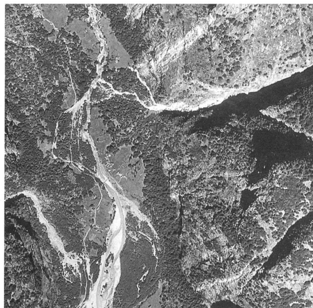
Bild 4b, oben. Ablagerungen des Murgangs vom 31. August 1992 auf dem Kegel des Ri di Foioi. Das alte Gerinne verlief auf der rechten Kegelseite. Der teilweise übermurtete Weiler Faèd befindet sich auf der linken Kegelseite, neben der Brücke über die Bavona. (Foto: F. Spinedi, Locarno-Monti, 12. September 1992)
