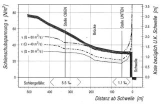
Bild 1. Längenprofil der Sihl bei Sihlwald (100fach überhöht).
