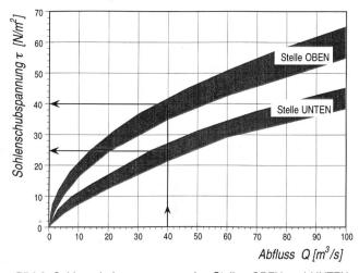
Bild 6. Sohlenschubspannung an den Stellen OBEN und UNTEN bei unterschiedlichen Abflüssen.
