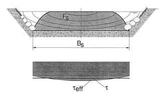
Bild 5. Isotachendarstellung der effektiven Geschwindigkeitsverteilung in einem Abflussquerschnitt mit erheblichem Wandeinfluss (oben). Schubspannungsverteilung, wie sie aus Geschwindigkeitsmessungen im Querschnitt bestimmt werden könnte, im Vergleich zur mittleren Sohlenschubspannung (unten).
