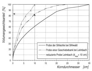
Bild 2. Kornverteilung des Unterschichtmaterials der Sihlsohle (Auswertung Linienzahlanalyse).
