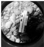
Bild 8. Nahaufnahme, blankgefegter Untergrund nach Hochwasser mit  $Q_{\text{max}} > 60 \text{ m}^3/\text{s}$ .
