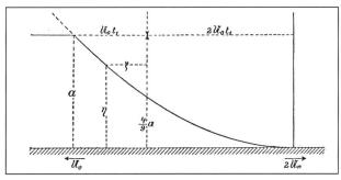
Bild R1. Verhältnisse eines Dammbruchs an der Sperrstelle.
