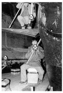
Bild 2. Vermessung der Laufschaufelkontur.
