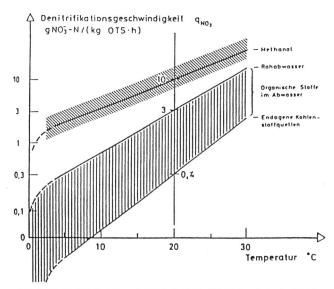
Bild 1. Denitrifikationsgeschwindigkeit als Nitratabnahme (g Nitrat-Stickstoff pro kg organische Trockensubstanz und Stunde, g NO<sub>3</sub>--N/[kg OTS·h]) in Abhängigkeit von Temperatur und Kohlenstoffquelle. Bei natürlichen Kohlenstoffquellen (vertikal gestrichelt) nimmt die Denitrifikationsgeschwindigkeit mit abnehmender Temperatur stark ab. Bei schlecht verfügbaren Kohlenstoffquellen (untere Gerade der gestrichelten Fläche) wird die Denitrifikationsleistung gering.
