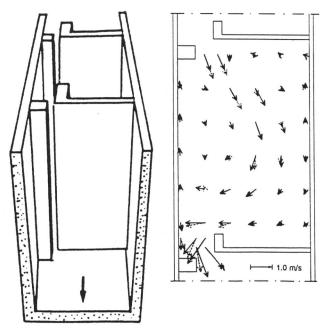
Bild 2, links. Vertical-Slot-Fischpass. Ansicht von Unterwasser.
