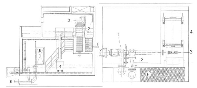
Figure 5. Coupe transversale du bassin d'eaux pluviales de Médières. 1 collecteurs Médières-Verbier, 2 compacteur, 3 tamiseur, 4 benne à déchets, 5 porte étanche, 6 départ conduite forcée.
