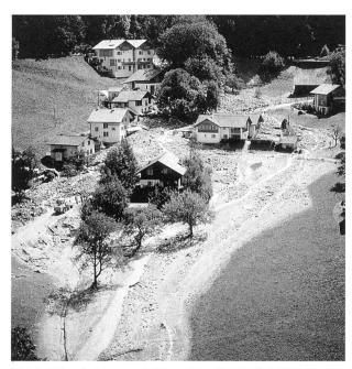
Bild 4. Rüfenniedergang ob Triesenberg FL, 31. Juli 1995. Die Geschiebeablagerungen aus dem «Krummen Zug» waren im Staubereich der Häuser bis drei Meter hoch. An acht Häusern im Ortsteil «Sütigerwis» wurden Keller, Garagen und Wohnräume mit Schlamm und Geschiebe gefüllt.
