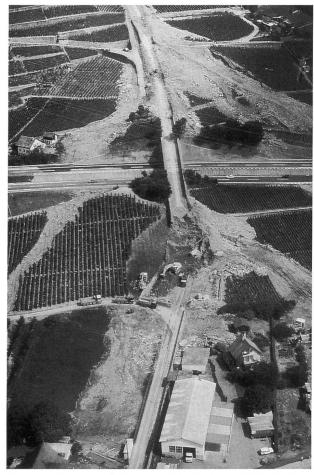
Bild 7. Der Murgang bei Villeneuve VD Mitte August 1995. Die Foto zeigt die Geschiebeausbrüche des «Pissotbaches» ober- und unterhalb der Genfersee-Autobahn.
