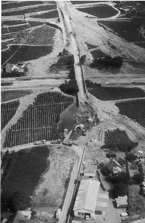
Bild 7. Der Murgang bei Villeneuve VD Mitte August 1995. Die Foto zeigt die Geschiebeausbrüche des «Pissotbaches» ober- und unterhalb der Genfersee-Autobahn. (Foto: Landeshydrologie und -geologie LHG, Ch. Lehmann, Bern)
