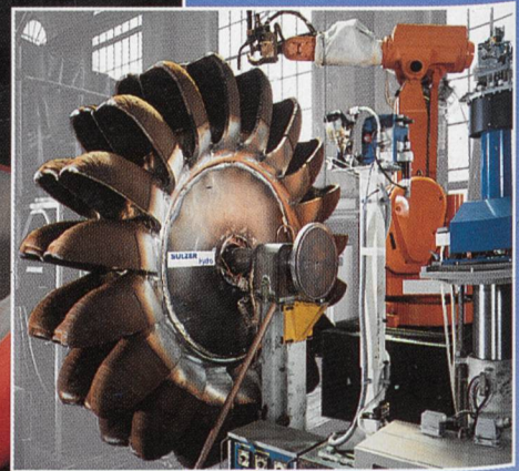
▲ Fertigung eines Pelton-Laufrades im MicroGuss-Verfahren
