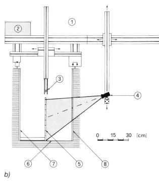
Bild 2. Versuchsanordnung des Vermessungssystems. a) Ansicht Messanlage, b) Querschnitt Messanlage: 1 Messwagen, 2 Kaltlichtquelle, 3 Linienlicht, 4 Video-Kopfteil, 5 Strichmaske in Kanalachse, 6 Kanalboden (PVC schwarz), 7 Kanalrückwand (PVC schwarz), 8 Kanalfrontseite (Glas).
