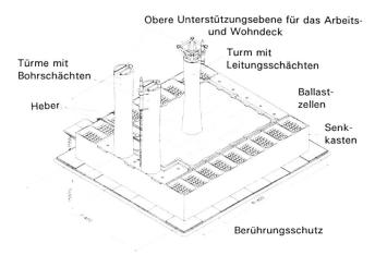
Bild 1. Aufbau der Betonplattform NAM F3 zur Öl- und Gasgewinnung in der Nordsee.
