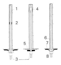
Spreizhülsenanker Kunstharzklebeanker Zementmörtelanker
