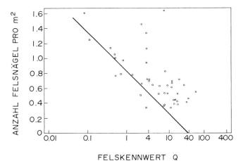
Bild 5. Diagramm zur Bestimmung der Ankerdichte (aus Rock Bolting Practical Guide von *Pierre Choquet*, basierend auf in kanadischen Minen ausgeführten Ankerungen ( $\bigcirc$ ); Norwegian Technical Institute).
