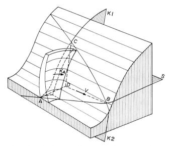
Bild 9. Gleitkeilanalyse am Widerlager einer Bogenmauer. K1, K2 Kluftflächen, S Schichtfläche,  $K_A$  Auflagerkraft, A-B-C-D möglicher Gleitkörper, V Verschiebungsrichtung.
