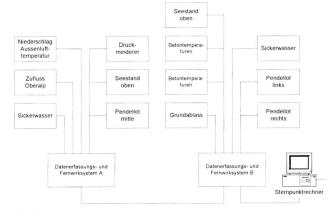
Bild 2. Das Blockschaltbild zeigt die Messwert-Erfassungsstationen und die Systemtopologie des Überwachungssystems innerhalb der Talsperre Curnera.
