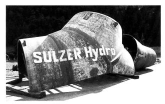
Bild 4. Panzerung für die Verteilleitung, gelagert auf dem Umschlagplatz Brindli.
