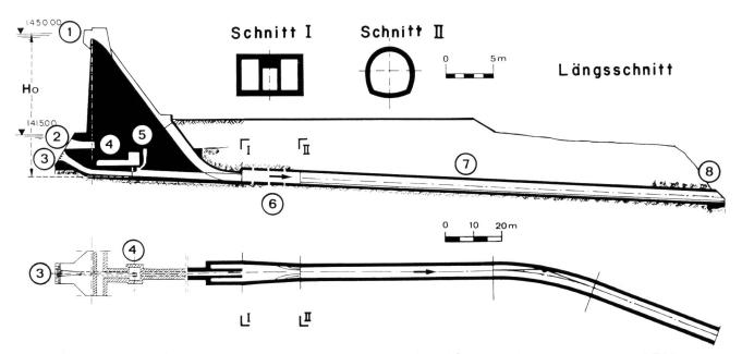
Bild 1. Sperranlage Panix: Stollen und Hochwasserentlastung in Längsschnitt und Situation. 1 Hochwasserentlastung, 2 Triebwasserfassung, 3 Grundablasseinlauf, 4 Schützenkammer, 5 Belüftung, 6 Vereinigungskammer, 7 Unterwasserstollen, 8 Stollenportal. Der 38 m lange Grundablass-Stollen liegt zwischen Schütze (4) und Vereinigungskammer (6). Die Gleitschütze ist 150 cm hoch und 110 cm breit, der Stollen weitet sich auf 240 × 150 cm auf.
