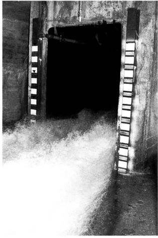
Bild 4. Fotoaufnahme der Strömung am Austritt aus dem Stollen des Grundablasses in Panix, beaufschlagt mit 15 m³/s und bei ca. 18 m/s Geschwindigkeit. Die vertikale Skala links weist eine Dezimeterteilung auf.
