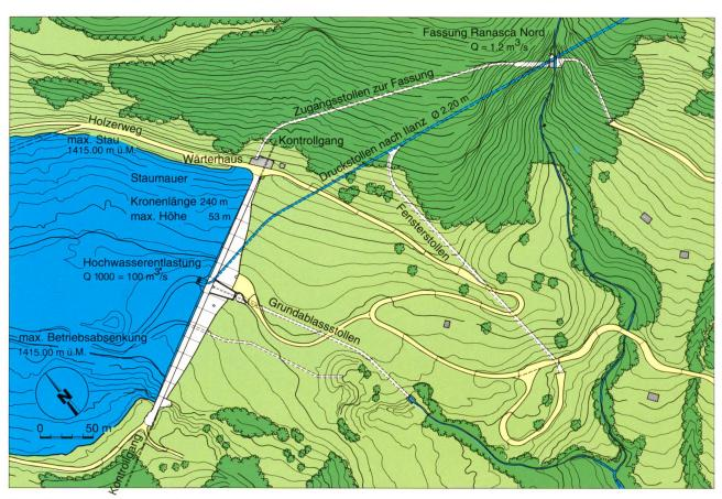
Bild 4. Situation der Staumauer Panix samt Nebenanlagen und Triebwassersystem.
