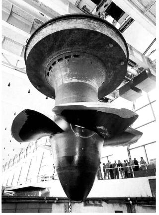
Bild 1. Kaplanturbine Birsfelden beim Herausnehmen für die Ertüchtigung im Werk Sulzer Hydro.
