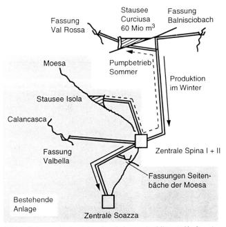
Bild 1. Schema der bestehenden Anlagen der Misoxer Kraftwerke AG mit den geplanten Erweiterungen Saisonspeicher Curciusa.
