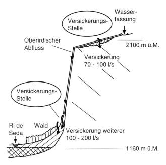
Bild 3. Längsprofil des Balnisciobaches mit der geplanten Wasserführung. Bei der Fassungsstelle beträgt die Abflussspitze im Hochsommer 1200 l/s, gefasst werden 500 l/s. Der Wert  $Q_{347}$  wird mit 13 l/s berechnet.
