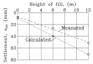
Bild 2. Berechnete und gemessene Rohrsetzung in das Polster.
