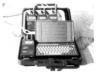
Bild 1. Messkoffer mit Subnotebook und Leitfähigkeitsmessgerät.
