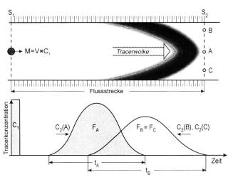
Bild 2. Prinzip der Abflussmessung nach dem Verdünnungsverfahren, nach [3] ergänzt.
