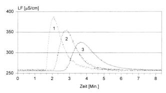
Bild 7. Durchgangskurven bei Anordnung der Sonden in Fliessrichtung (Messanordnung vgl. Text); Versuch Spissibach, Leissigen, vom 5. Juli 1994.
