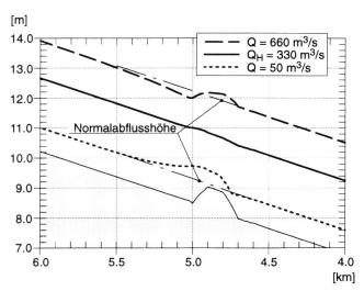
Bild 7. Wasserspiegel verschiedener Abflüsse in der kurzen Aufweitung. Der «Hügel» hat sich bei einem konstanten Abfluss von  $Q_{\mbox{\tiny H}}=330~\mbox{m}^{\mbox{\tiny 3}/\mbox{\tiny S}}$  gebildet.
