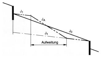
Bild 4. Die lokale Aufweitung als sohlenstabilisierendes Element. Auswirkungen einer Gerinneverbreiterung auf das Längenprofil (aus *Zarn* 1992).  $J_0$  = Gefälle der Ausgangssohle,  $J_1$  = Gefälle der erodierten Sohle,  $J_A$  = Gefälle in der Aufweitung.
