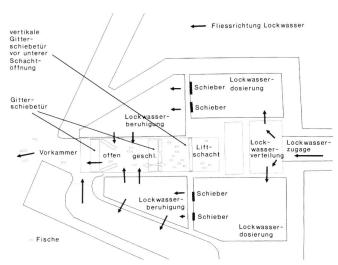
Bild 3. Grundriss auf Höhe der unteren Liftschachtöffnung der Anlage Golfech mit Vorkammer und Gitterschiebetüre. Die Gitterschiebetüre (siehe Text) ist offen, in Fangposition, und geschlossen, in «Verdichtungsposition», eingezeichnet. Vor dem Liftschacht ist die vertikal schliessende Gitterschiebetür eingezeichnet, die das Eindringen von Fischen während des Hebevorganges verhindert.
