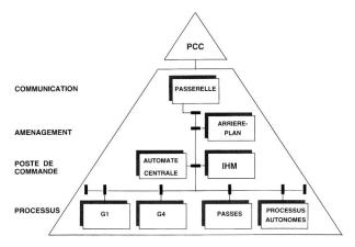
Figure 1. Schéma: Poste de commande centralisé (PCC) et le système hiérarchique.
