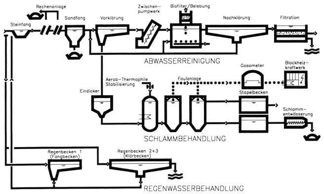
Bild 3. Funktionsschema der ARA Ergolz 1.
