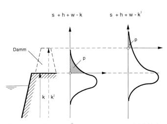
Bild 2. Verminderung der Überschwemmungswahrscheinlichkeit, oben durch Rückhaltemassnahmen im Einzugsgebiet, unten durch Vergrösserung der Abflusskapazität (beispielsweise mit Längsdämmen).
