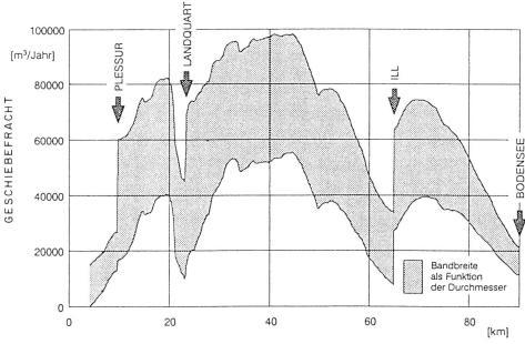
Bild 3. Ergebnis einer Berechnung mit Mormo: jährliche Geschiebefracht des Alpenrheins zwischen Domat/Ems (km 4,2) und Bodensee (km 90) in der Periode von 1974 bis 1988. Ein Anstieg der Kurve bedeutet eine Erosion der Sohle oder einen Geschiebeeintrag durch einen seitlichen Zufluss. Ein Fallen bedeutet, abgesehen von den Folgen des Abriebs, eine Auflandung der Sohle oder eine Geschiebeentnahme.
