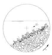
Bild 4. In einer Trommel von 1,05 m Innendurchmesser wurde der Abrieb der Geschiebekörner experimentell bestimmt. Diese Laborversuche stützen den bereits in den numerischen Simulationen ermittelten Sternberg-Koeffizienten c von 0,01 bis 0,015 pro km.
