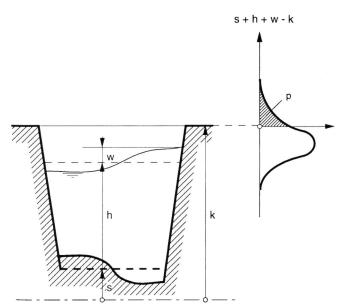
Bild 1. Schematischer und überhöhter Flussquerschnitt mit der Sohlenkote s, der Wassertiefe h und der Wellenhöhe w sowie der Uferkote k. Wahrscheinlichkeitsverteilung von s+h+w-k und Überschwemmungswahrscheinlichkeit p.
