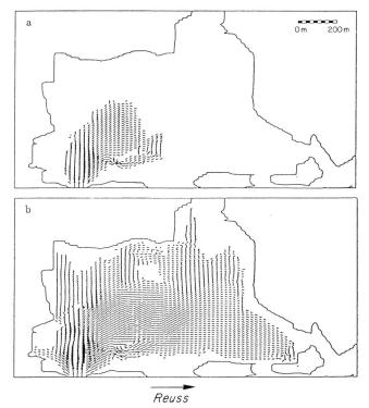
Bild 8. Ergebnis einer Berechnung mit einem 2D-Abflussmodell: Ausuferung der Reuss bei Attinghausen durch eine Dammbresche 1987. Zustände a) nach 0,5 h, b) nach 0,7 h. Nach 1,8 h ist das gesamte umrandete Gebiet betroffen; es erfolgen dann verschiedene Rückströmungen in die Reuss.
