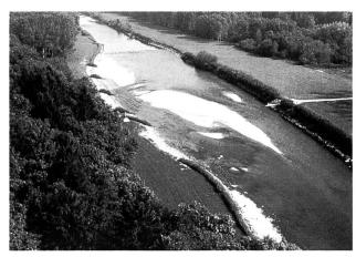
Bild 6. Flussaufweitung an der Thur bei Pfyn zur Erhöhung der Strukturvielfalt am Gewässer (Foto: Amt für Umweltschutz TG).
