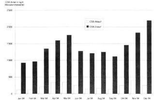
Graphik 1. Vergleich des chemischen Sauerstoffbedarfes (CSB) im Zulauf vor der Reinigung und im Ablauf nach der Reinigung. 1994 betrug der durchschnittliche CSB-Abbau 84%.
