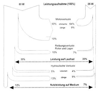
Bild 2. Leistungsflüsse zweier typischer Kleinumwälzpumpen.
