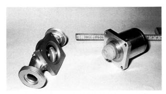
Bild 4. Geöffnete Pumpe mit 10 W Wellenleistung und 28-mm-Laufrad.
