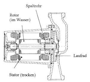
Bild 1. Schnitt durch Heizungsumwälzpumpe (Nassläufer mit Spaltrohr).
