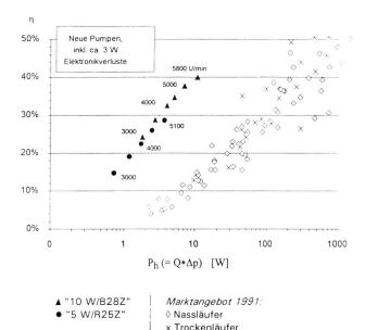
Bild 5. Gesamtwirkungsgrade von Umwälzpumpen in Abhängigkeit der Umwälzleistung  $P_h$  ( $P_h = Q^*\Delta p$ ).
