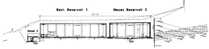
Bild 4. Grundriss und Querschnitt. Reservoir Lyren Zürich: Die Anlage liegt ca. 100 m über dem Limmattal und versorgt zusammen mit den Anlagen Frauenthal und Höngg die Limmatzone, deren Gesamtbedarf an Trinkwasser ca. 100 000 m³/Tag beträgt.
