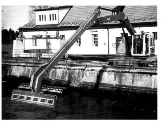
Rechen abgereinigte Rechengut in der Greiferharke aufgenommen. Danach fährt der Reiniger zur Abwurfgrube und wirft das Rechengut nach einer 120°-Drehung direkt in die Grube. Der Handbetrieb dient überwiegend dazu, ungünstig vor dem Rechen oder dem Leerschuss liegendes, sperriges Rechengut mit der Greiferharke aufzunehmen und zur Abwurfgrube zu transportieren.
