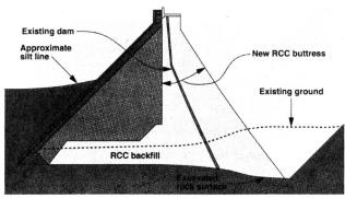
Bild 1: Vorgesehene Verstärkung der Bogenstaumauer.
