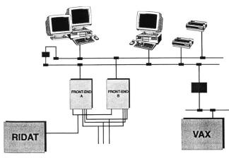
Figure 9. Les deux passerelles à raccorder le nouveau centre Landis & Gyr aux installations existantes.
