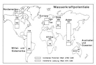
Bild 1. Wasserkraftpotentiale der Welt.
