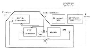
Figure 7. Schéma de la commande prédictive type PFC à modèle interne non linéaire.
