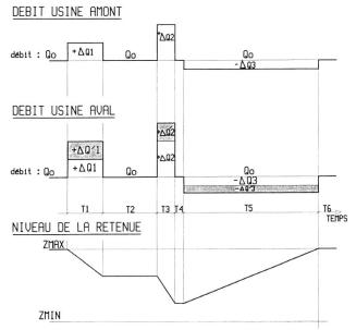
Figure 5. Principe d'une écluse – évolution du niveau en amont et en aval.
