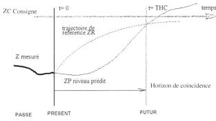
Figure 6. Principe de la commande prédictive.
