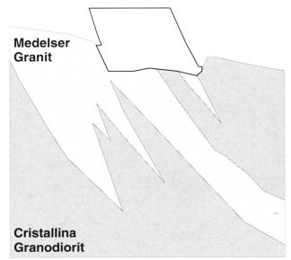
Bild 4. Schematischer Querschnitt durch den Mauerfuss.
