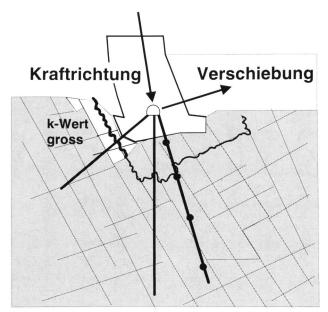
Bild 10. Postulierter Mechanismus bei Teilstau.
