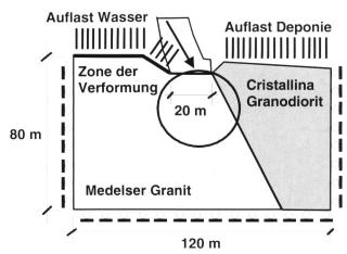
Bild 13. Lasten und Lagerungen für die Berechnung.
