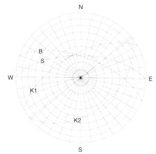
Bild 3. Trennflächengefüge, Schmidsches Netz, untere Halbkugel.
