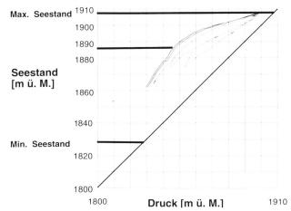
Bild 6. Gemessene Kluftwasserdrücke in Abhängigkeit des Seestandes.
