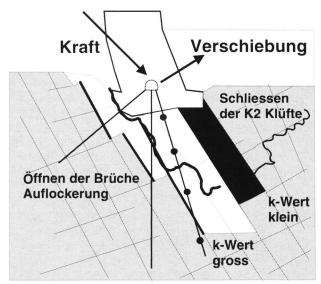
Bild 11. Postulierter Mechanismus bei Vollstau.
