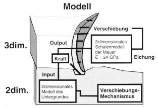
Bild 12. Schematische Darstellung der numerischen Berechnungen.
