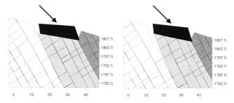
Bild 18 (links). Verschiebung der Blöcke (200fach vergrössert), Kohäsion der Kontaktfuge =  $250.0 \, (kN/m^2)$ .
