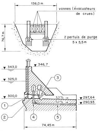
Figure 3. Barrage de Dashidaira. Organes de dégravement de la retenue vus de l'amont et en coupe longitudinale.
