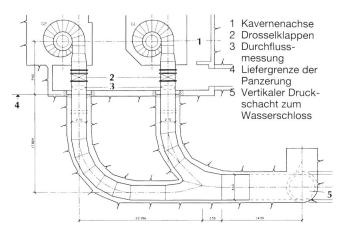
Bild 2. Verteilleitung und Turbinenspiralen Kraftwerk Pradella-Martina.
