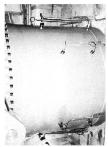
Bild 3. Messrohr mit Sonden.
