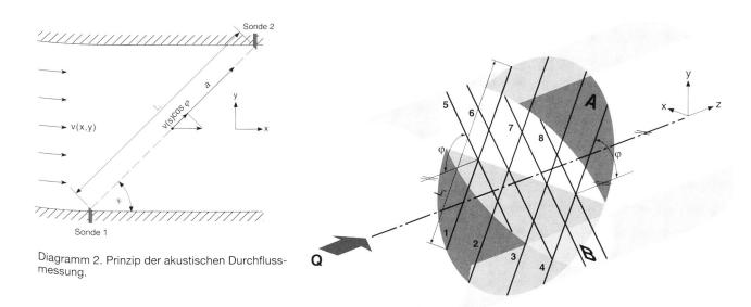
Diagramm 3. Akustische Durchflussmessung mit 8 Pfaden in 2 Ebenen.
