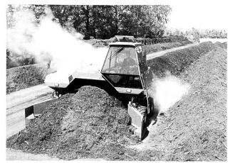
Die neue, selbstfahrende Kompostwendemaschine Topturn 3000 S von Aebi-Komptech hier in der Kompostieranlage Murimoos/Aargau im Einsatz.
