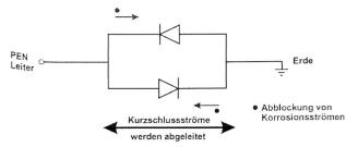
Die IXYS-Diodenabgrenzeinheiten, die durch ABB Normelec AG, Zürich, vertrieben werden, bieten einen umfassenden Korrosionsschutz durch Sperrung des korrosionsfördernden Gleichstromes. Der Personenschutz ist durch die einwandfreie Ableitung von Kurzschlussströmen gewährleistet.
