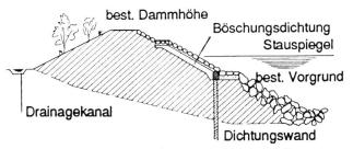
Bild 3. Dammquerschnitt (modifizierte Figur B 11, S. 30, Hauptbericht).
