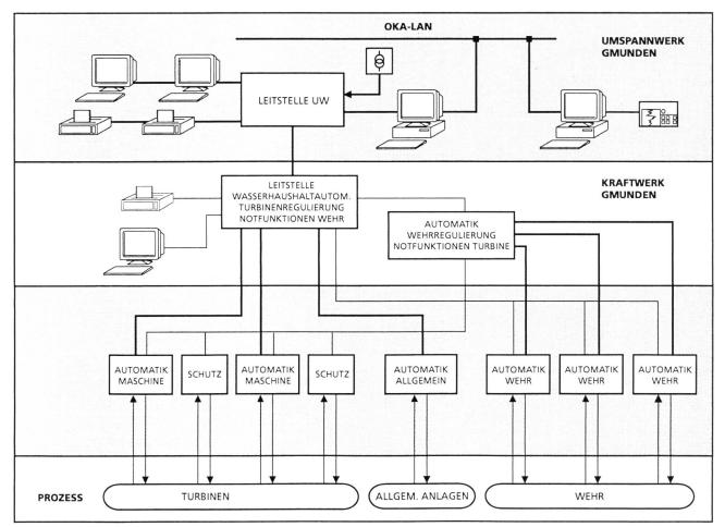
Bild 3. Leittechnikkonzept Kraftwerk Gmunden.
