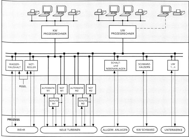
Bild 1. Leittechnikkonzept Kraftwerk Wynau.
