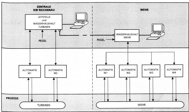
Bild 5. Leittechnikkonzept Kraftwerk Reichenau.
