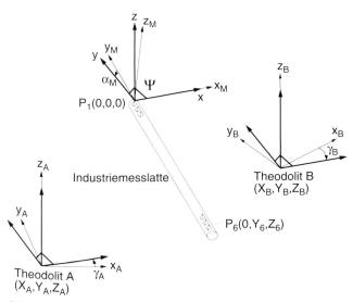
Bild 1. Kalibrierung des Messsystems mit der Industriemesslatte.
