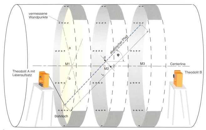
Bild 3. Vermessungsverfahren in runden Rohren.
