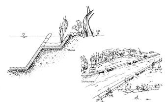
Bild 3. Vorschlag für die Auflösung der geraden Uferlinie eines Triebwasserkanals mit Hilfe von «Öko-Buchten» (Hailmair/Maile).
