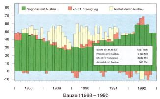
Bild 7-4. Ausbau Rheinkraftwerk Laufenburg – Erzeugung pro Monat (in Mio kWh).
