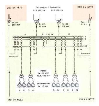
Bild 6-20 Schematischer Aufbau der neuen Energieableitung.
