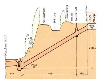
Bild 6-21. Längenprofil des Kabelstollens für die Energieableitung.
