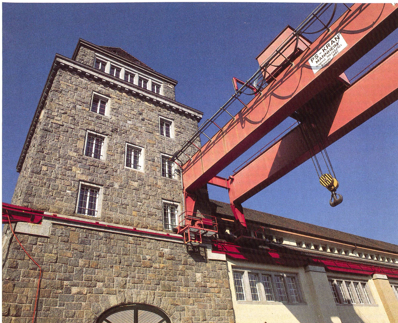
Bild 6-31. Der neue 100-Tonnen-Kran leistete bereits beim Ausbau wertvolle Dienste.
