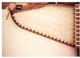
Bild 5-11. Strömungsbild mit Wollfäden bei einem Ausbaudurchfluss der zehn Turbinen von insgesamt 1400  $\rm m^3/s.$
