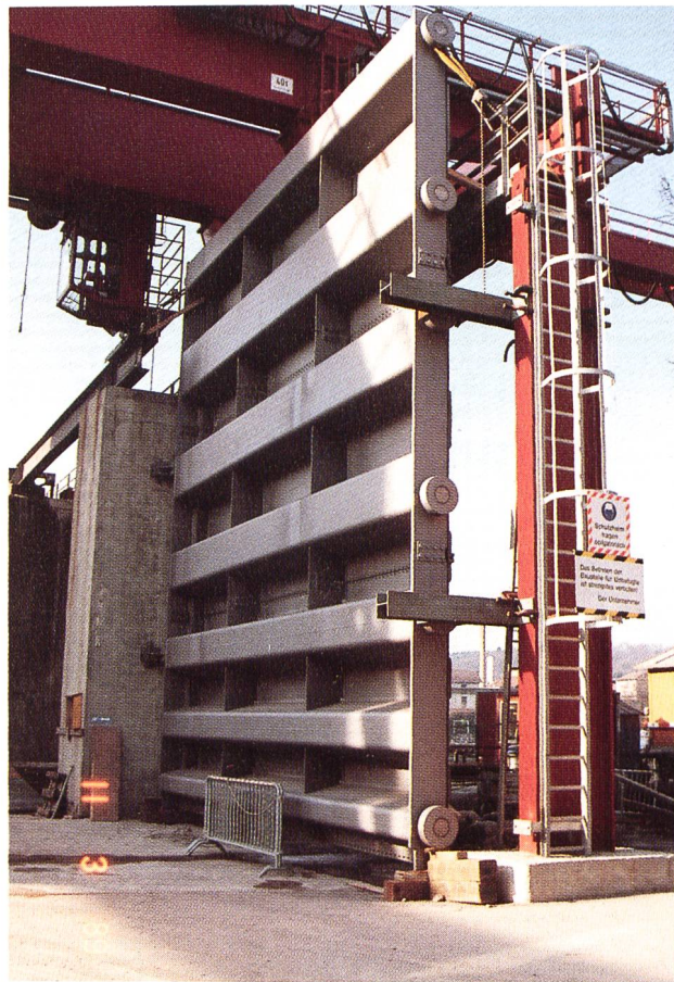
Bild 6-17. Anstelle von Einlaufschützen und Gleitdammbalken dienen jetzt Rolldammtafeln als oberwasserseitige Abschlüsse der Turbineneinläufe.
