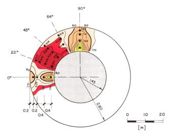
Bild 5-9. Vorgeschlagene Einlaufvariante  $Q=145~\text{m}^3/\text{s}$ : Isotachenbild (Linien gleicher Durchflussgeschwindigkeit in m/s) des Messprofils 4.
