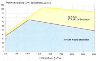
Bild 7-1. Leistungskurve Rheinkraftwerk mit 10 Straflo-Turbinen. Prognose Normalstau mit Baggerung durch das Rheinkraftwerk Säckingen.
