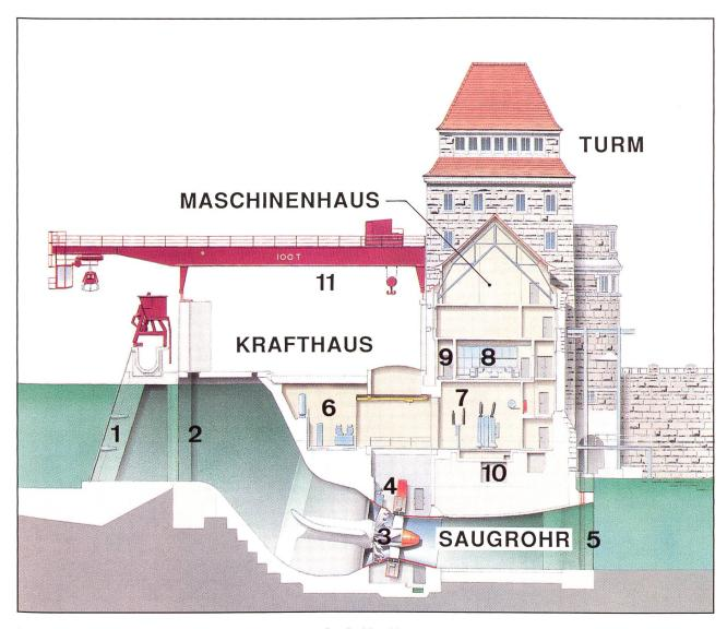
Bild 5-17. Schnitt durch das Rheinkraftwerk mit den neuen Straflo-Maschinengruppen, die sich *unterhalb* des Unterwasserspiegels befinden. 1 Rechen, 2 Rolldammbalken-Nut, 3 Straflo-Turbine, 4 Aussenkranzgenerator, 5 Unterwasser-Dammtafelnut, 6 hydraulischer Turbinenregler, 7 Maschinentransformator, 8 Kommandoraum, 9 Energieableitung, 10 Rohrkanal.
