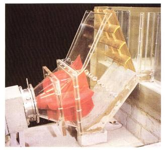
Bild 5-7. Modell des fertig montierten Turbinenblocks.
