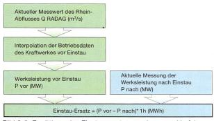
Bild 8-2. Ermittlung des Einstauersatzes nach neuem Verfahren.
