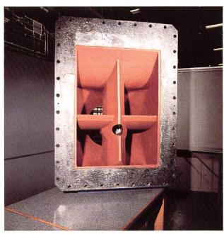
Bild 6-12. Turbineneinlaufmodell.
