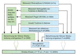
Bild 8-1. Bisheriges Verfahren zur Ermittlung des Einstauersatzes.
