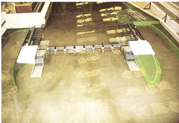
Bild 8. Im Wasserbaulabor der Technischen Universität Karlsruhe wurden die verschiedenen Ausbauvarianten im Modell 1 : 50 strömungsmässig untersucht. Im Bild die Variante mit zwei grossen Rohrturbinen in der Wehrachse.
