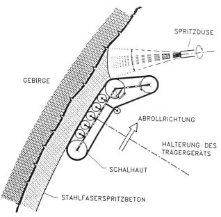
Bild 1. Holzmann-Rollschalung für Spritzbetonauftrag für einschalige Tunnelauskleidung.
