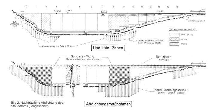
nen Dammabschnitte eingebaut. Die Sickerwassermengen gingen danach um 92 % zurück. So versiegten die 14 l/s Sickerwasser aus den Blöcken 8 und 9 am rechten Hang innerhalb von etwa 50 Arbeitstagen. Zusammen mit der Sanierung an den Blöcken 0 bis 2 (Bild 2) wurde die Gesamtsickermenge von 23,5 auf 4,1 l/s verringert.
