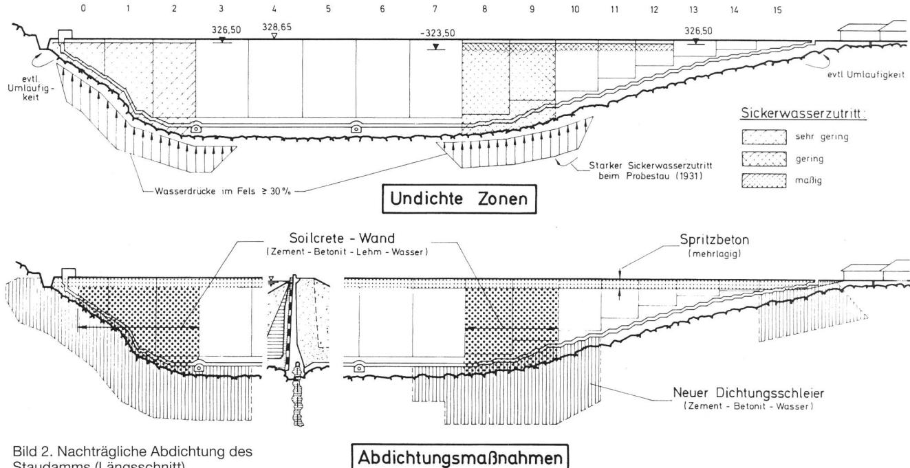
Bild 2. Nachträgliche Abdichtung des Staudamms (Längsschnitt).
