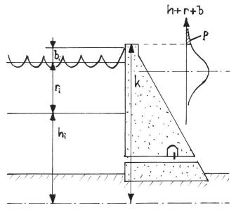
Bild 1. Talsperre mit Stausee. Wasserstand h bei Hochwasserbeginn, Höhe r des vom Hochwasser beanspruchten Stauraumes, windwellenbedingtes Freibord b, Kronenhöhe k, Überflutungswahrscheinlichkeit p (Index i für einen Einzelfall).
