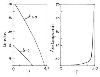
Bild 2. Überflutungswahrscheinlichkeit in Funktion verschiedener Parameter: Links die Breite des Stirnüberfalls in Metern mit und ohne Vorgabe eines (konstanten) Freibords, rechts die Anstiegszeit der Hochwasserwelle in Stunden (bei Anstiegszeiten unter 10 Stunden ist hier das Ergebnis sensitiv, bei grösseren Werten nicht).
