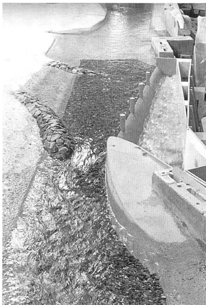
Bild 2. a) Physikalisches Modell des Entlastungsbauwerkes Lenzburg an der VAW mit Blick gegen die Fliessrichtung. Die Zulaufwassermenge Q_z beträgt 15 \text{ m}^3/\text{s} . (VAW 45/32–10). b) Hydraulische Elemente am Entlastungsbauwerk, 1. Überfallkante, 2. Sammelkanal, 3. Übergangsbereich, 4. Einlaufbereich, 5. Entlastungstollen, 6. Buhnen.
