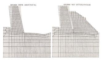
Bild 1. Felsmechanische Untersuchungen für die Sanierung der Kölnbreinsperre. Verformung der Gründungszone bei Vollstau. Sperre ohne Abstützung (links) und Sperre mit Stützgewölbe (rechts).
