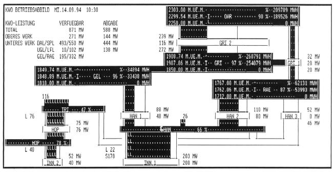
Bild 3. Dieses Betriebsabbild wird alle 15 Minuten aktualisiert und kann von den Partnern abgefragt werden. Die KWO-Anlagen im Modell; weggelassen sind die Teile, die nur der Laufwasserverarbeitung dienen.
