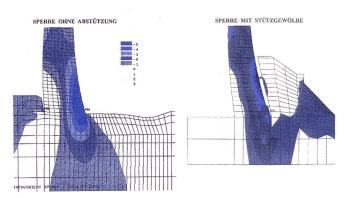
Bild 2. Felsmechanische Untersuchungen für die Sanierung der Kölnbreinsperre, Zonen gleicher Vertikalspannungen bei Vollstau (Schnitt Block 16). Sperre ohne Abstützung (links) und Sperre mit Stützgewölbe (rechts).
