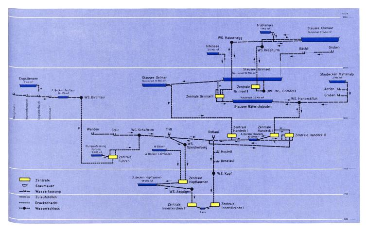
Bild 2. Hydraulisches Schema der Kraftwerke Oberhasli.
