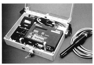
Bild 3. Datenlogger und Leitfähigkeitsmesssonde. Der Logger speichert während des Durchgangs der Salzwolke sekundlich die gemessenen Leitfähigkeiten. Diese Daten werden über eine Schnittstelle einem Laptop-Computer überspielt (Bild WSL).
