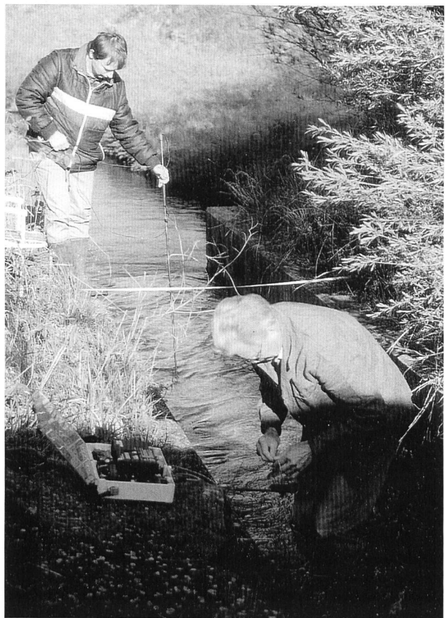
Bild 1. Feldequipe während einer Vergleichsmessung. Im Hintergrund wird die Abflussmessung mittels Kleinflügel durchgeführt. Im Vordergrund werden der Datenlogger und die Leitfähigkeitssonde für die Salzverdünnungsmessung vorbereitet.
