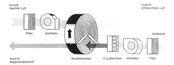
Bild 3. Funktionsschema Munters-Luftentfeuchter.
